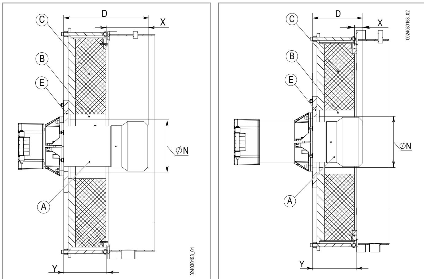
Проникновение головки горения должно определяться в соответствии с инструкциями производителя генератора.
